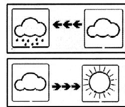
Las flechas apuntadas hacia la derecha indican un aumento de la presión y una mejora meteorológica. Las flechas apuntadas hacia la izquierda indican una disminución de la presión y una degradación meteorológica.
