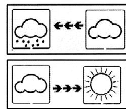
Les flèches pointées vers la droite indiquent une augmentation de la pression et une amélioration météorologique. Les flèches pointées vers la gauche indiquent une diminution de la pression et une dégradation météorologique.
